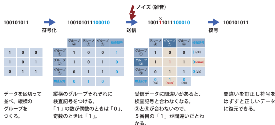
図2 パリティ検査によるエラー訂正例
